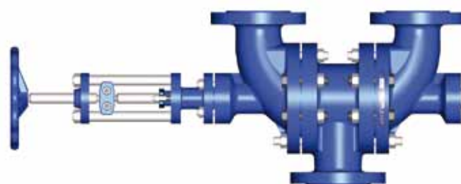
Тип 310 Конструкция с сильфоном
